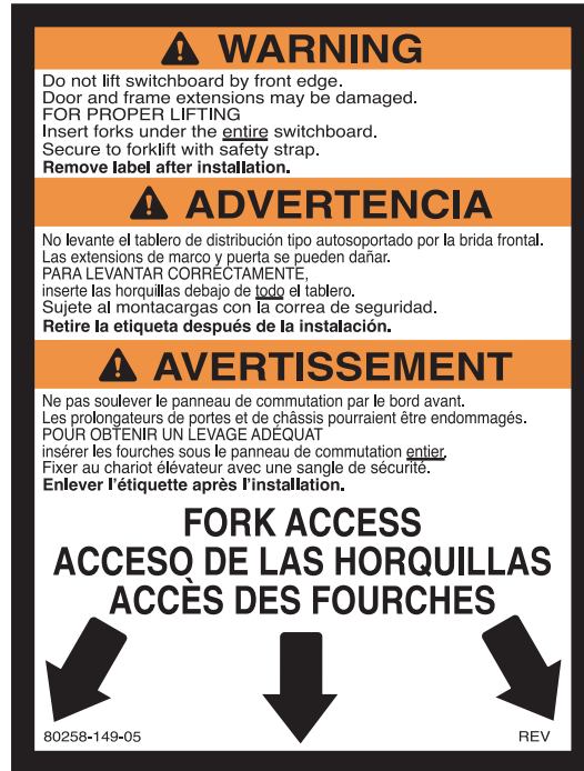
Figure 2 : Étiquette d'avertissement, panneaux de commutation à l'épreuve de la pluie
